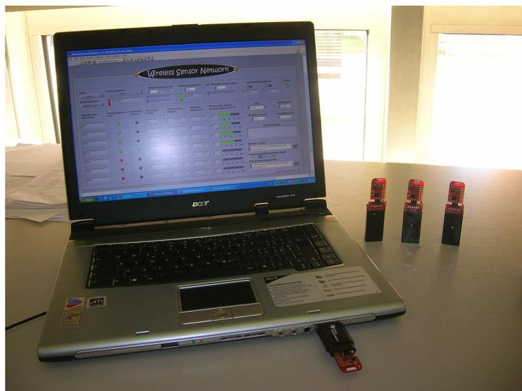
Figura 13 Rete di sensori wireless realizzato
