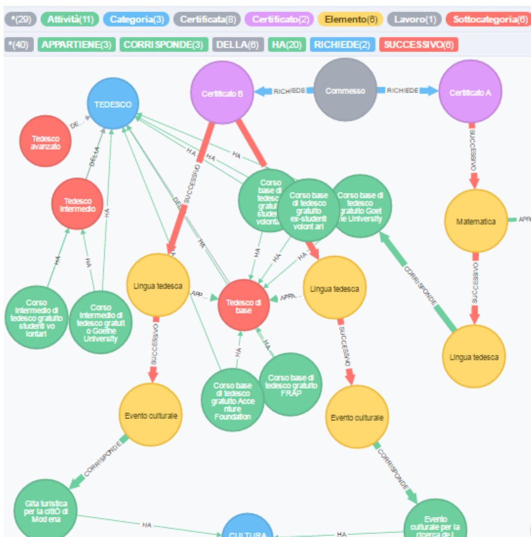
Figura 59 Istanza del database visualizzata tramite la console di Neo4j. In alto, sono mostrate le varie etichette ed i tipi di relazione con i colori associati. In basso, si può notare un nodo lavoro, “Comnesso”, che richiede 2 certificati, “A” e “B”, con i vari percorsi di formazione associati.
